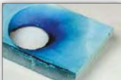
Ekstruderet polystyren (XPS), brandhæmmende, efter 1 min.
