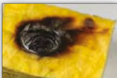
Mineraluld på glasbasis efter 7 minutter.
