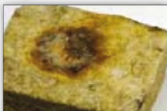
ROCKWOOL stenuld efter 30 minutter.
